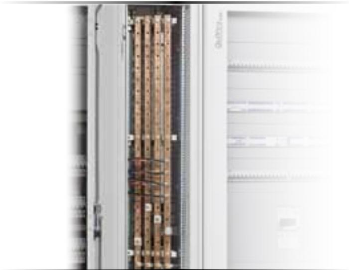
Лестничная шина может быть установлена вертикально в панели шириной 12 модулей и горизонтально в панелях шириной 24 и 36 модулей. В любом случае, она не может располагаться наверху.
